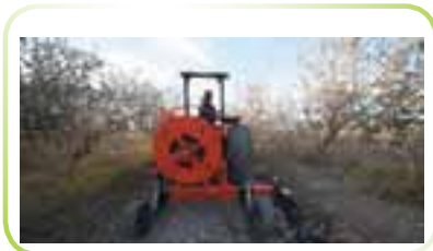
دستگاه ویژه نصب لوله های PC2
